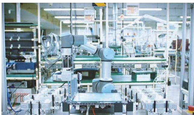
Vákuový uchopovač zvládne premiestniť tri dosky plošných spojov naraz.
