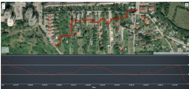
„Pravidelná kontrola plynovodov je dôležitá pre bezpečnú prevádzku plynárenskej siete, takže drony postupne nachádzajú uplatnenie aj v tejto oblasti,“ vysvetľuje M. Ševera. Na obrázku je zaznamenaná trasa preletu a pod ňou údaje o koncentrácii metánu.
