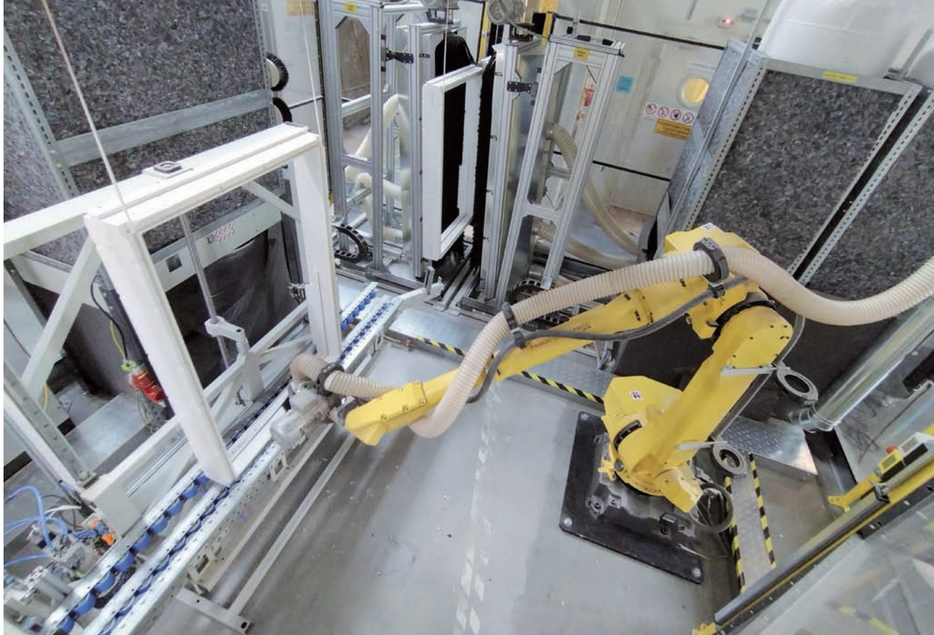
Robot odstraňuje pomocou čistiacej kefy z komponentov prach a piliny.
