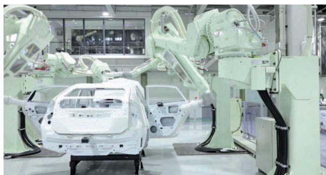
Využitie robotov Kawasaki v striekacej linke pre automobily
